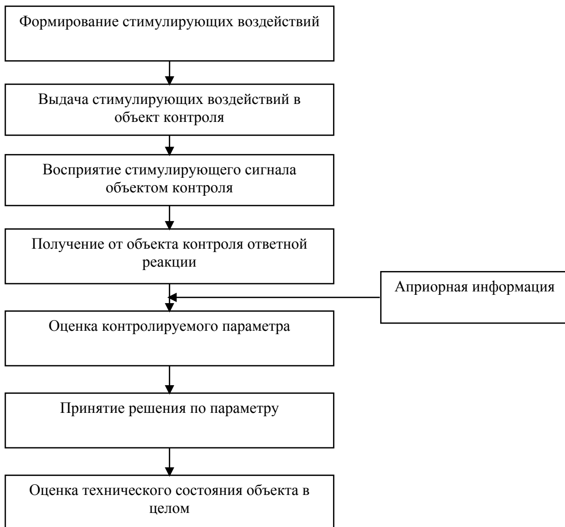
Рисунок 5.3 – Схема проверки технического состояния объекта контроля
